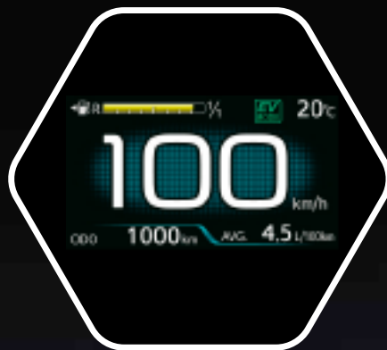
EV MODE: Funcionamiento con el motor eléctrico.
