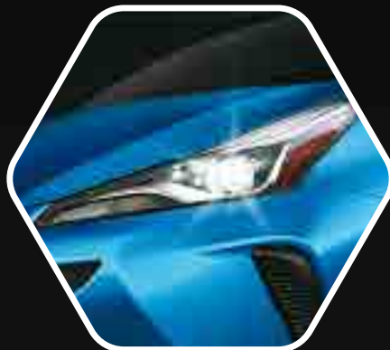
Faros delanteros Bi-LED con nivelación automática en altura y sensor crepuscular.
